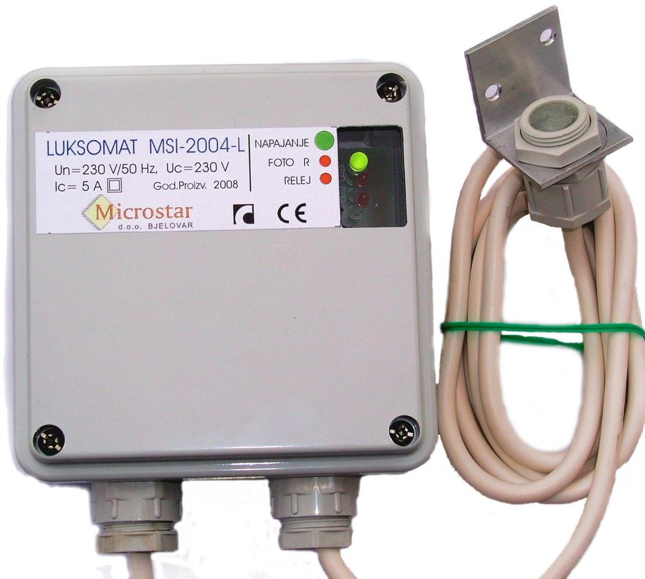
Luksomat MSI-2004-L / MSI-2004-LI služi za uključivanje strujnih krugova nailaskom noći odnosno isključivanje nailaskom danjeg svjetla. Za tu svrhu koristi se jedan galvanski odvojen relej s mirnim i radnim kontaktom. Napajanje uređaja je realizirano pomoću kodenzatora. Time je luksomat, kao trošilo, kapacitivog karaktera i iz mreže kompenzira induktivnu komponentu koje u mreži uglavnom ima viška.
