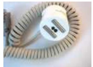
Okretanjem druge strane sonde na raspolažanju nam je **magnetni** međusklop (**IEC-1142**) za očitanje RIZ-ovih brojila prislanjanjem na očitačku kutiju i pritiskom na tipku ručnog terminala. Na jednoj očitačkoj kutiji može biti priključeno do 100 elektroničkih brojila, koje će ručni terminal sve pročitati nakon jednog pritiska na adekvatnu tipku s prikazom podataka potrošača koji se trenutno očitava, na LCD pokazivaču.
