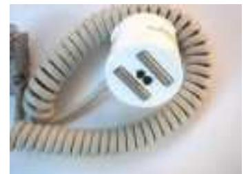
Okretanjem druge strane sonde na raspolažanju nam je **magnetni** međusklop (**IEC-1142**) za očitanje **RIZ-ovih brojila** prisljanjenjem na očitačku kutiju i pritiskom na tipku ručnog terminala. Na jednoj očitačkoj kutiji može biti priključeno do 100 elektroničkih brojila, koje će ručni terminal sve pročitati nakon jednog pritiska na adekvatnu tipku s prikazom podataka potrošača koji se trenutno očitava, na LCD pokazivaču.
